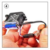
Verbinden Sie nun den Ausgang der ServoBridge mit dem Servoeingang (4). Um Verluste zwischen P²- ServoBridge und Servo klein zu halten empfehlen wir das Kabel am Servo zu kürzen und einen neuen Stecker (Best.Nr. 1060) aufzucrimpen.
